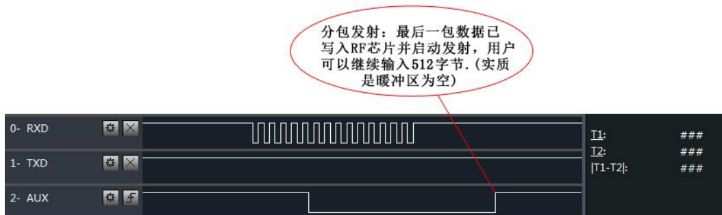
模块接收串口数据时，AUX引脚时序图
