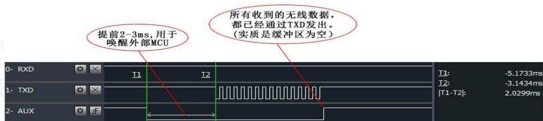
模块串口外发数据时，AUX引脚时序图
