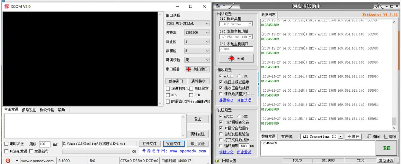
当设置为 (10, 1000) 时，发送 1K 的文件后数据会被分成串口打包长度 10 字节的数据段转发，总量不会变，若最后一次数据不足 10 字节，会等待串口打包时间 1000 毫秒后没有再收到数据时转发，如有数据继续以上步骤。
