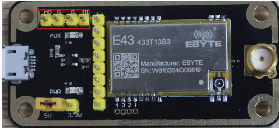
如图所示，插接好跳线帽（选择 5V 供电，模式 3），具体功能请参照相应的串口模块手册。
