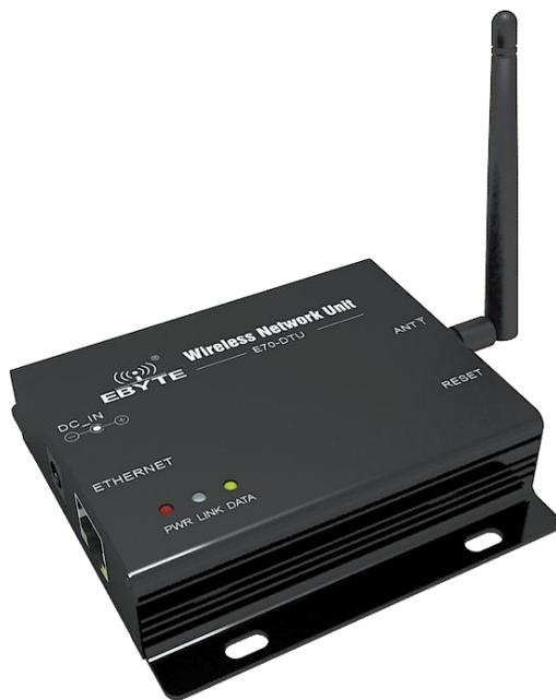
E70-DTU(433NW30-ETH)是星型网络系统，工作在 433MHz 频段，模块集协调器、终端为一体，具有长距离、高速率两种传输模式，最大支持 200 个节点同时并发数据到协调器，所有操作配置采用客户方便的上位机操作模式，极大简化用户操作，适用于多种无线通讯组网场景。
