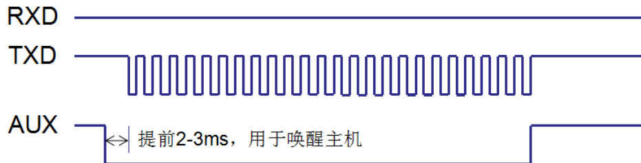
模块串口发送数据时AUX引脚时序图
